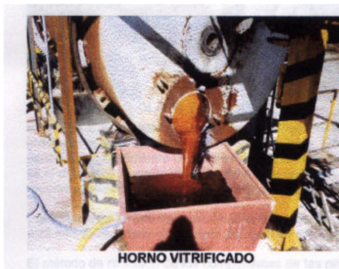
Foto 2. Salida del horno del material vitrificado
